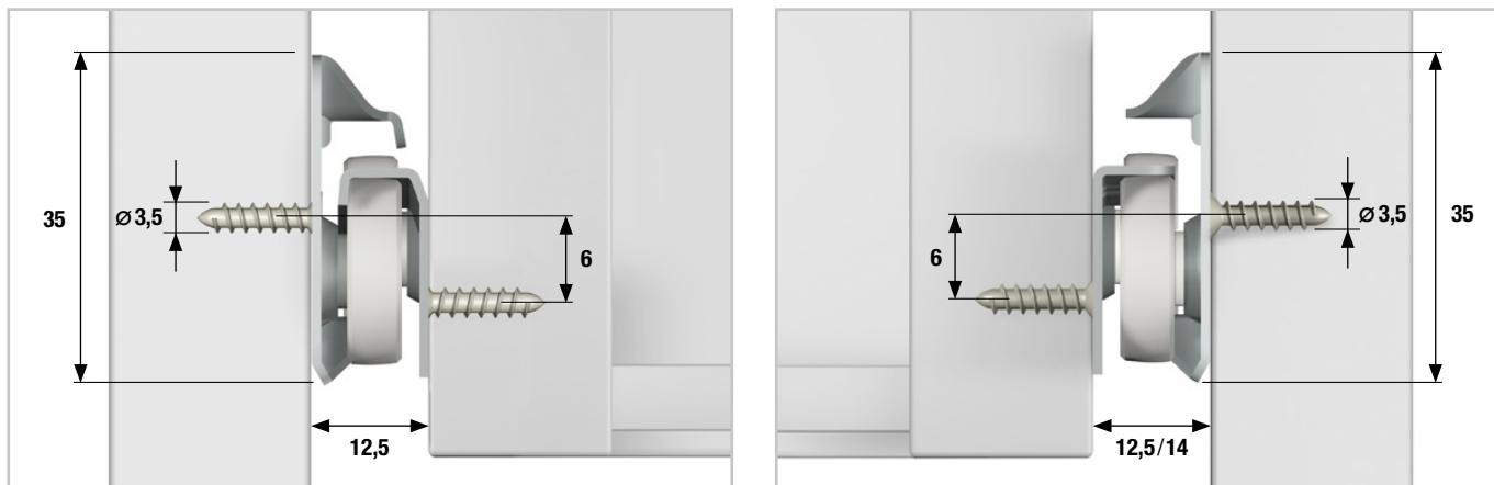
Foratura a passo 32 mm | Profili in acciaio spessore 1,00 e 1,10 mm | Finitura: acciaio verniciato.
